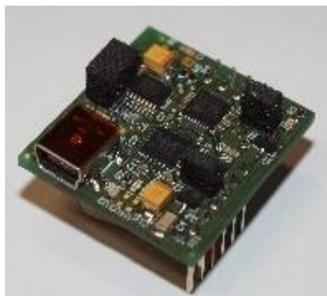
Obrázek kombinované sensorové platformy (KBI2C) pro senzory plynů NO 2 a NH 3 (vlevo), Teplotní pole sensorové platformy KBI2C (vpravo)
